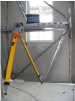
((Abb. 7, Flexijet_Baustelle.jpg)) Die Aufmaßdaten werden kabellos an das nicht zum Lieferumfang gehörende Notebook übermittelt
