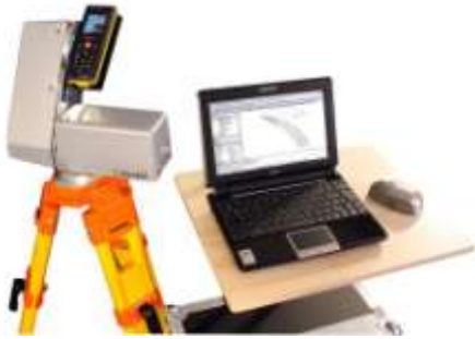
((Abb. 6, Flexijet_komplett.jpg)) Zum System gehören ein Koffer mit praktischer Notebook-Auflage, ein Stativ, ein Laser-Distanzmessgerät samt Dreh-/Schwenkeinheit sowie eine Aufmaß-Software
