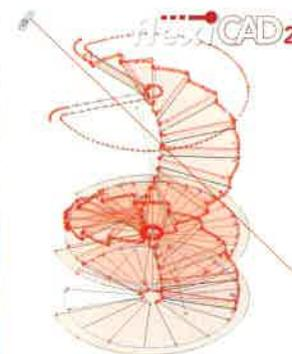
Treppensoftware übertragen werden, um die Stufen weiter zu bearbeiten. Dadurch konnte zu jeder Zeit auf eine 3D-Ansicht zurückgegriffen werden, so dass während der Bearbeitung stets eine optische Kontrolle möglich war. Neben Arbeitersparnis profitierte die Firma Schmidmayer auch von der Sicherheit, die der Einsatz dieser modernen CAD-Systeme mit sich bringt. ■
